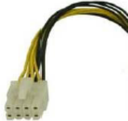
Conector hembra ATX P2 de ocho pines
