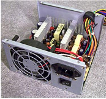
Las fuentes de alimentación son un elemento, dentro del hardware, muy importante. Es un dispositivo que convierte la tensión alterna de la red de suministro en una o varias tensiones, prácticamente continuas, que alimentan los distintos circuitos del aparato electrónico al que se conecta (ordenador, televisor, impresora, router, etc.).
