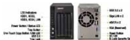
Este dispositivo de almacenamiento masivo es compacto, admite hasta cuatro discos duros de 2.5 pulgadas de tamaño, con dos conexiones Ethernet en la parte trasera, dos puertos USB y otros tantos eSATA, todos ellos para conectar otros dispositivos de almacenamiento externos, como por ejemplo discos duros.
