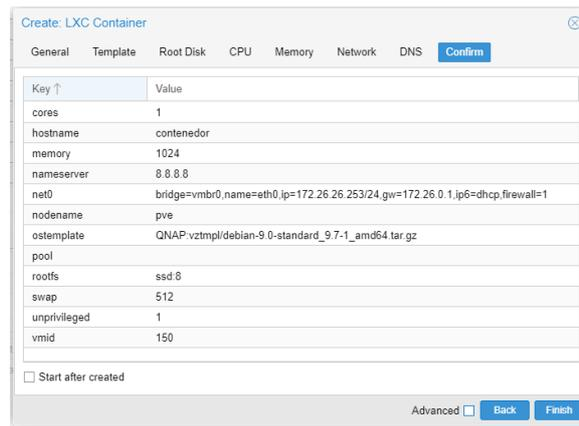
Hemos podido comprobar que las opciones de configuración son más sencillas que con la máquina virtual, ya que tenemos menos opciones. Por ejemplo, no hemos tenido que seleccionar un modelo de procesador, ya que la virtualización se hace directamente sobre el nodo Proxmox de forma aislada.
