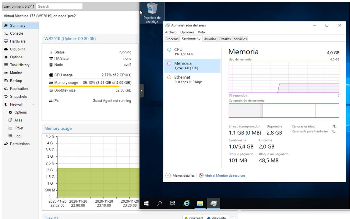
Para realizar la instalación copiamos el contenido de la carpeta D:\Ballon\2k19\amd64 a C:\Program Files\Balloon, y ejecutamos blnsvr.exe -i.
