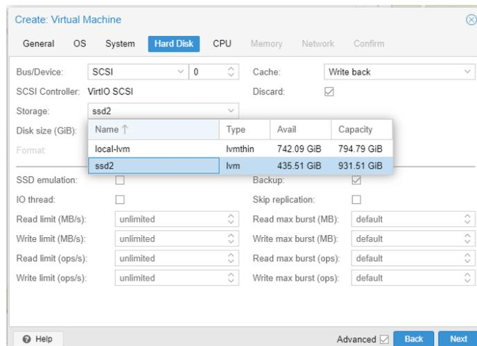
En Cache, indicaremos Write back para mejorar la velocidad de acceso y marcaremos Discard para hacer un uso óptimo del espacio real de disco, sobre todo si utilizamos almacenamiento thin.
