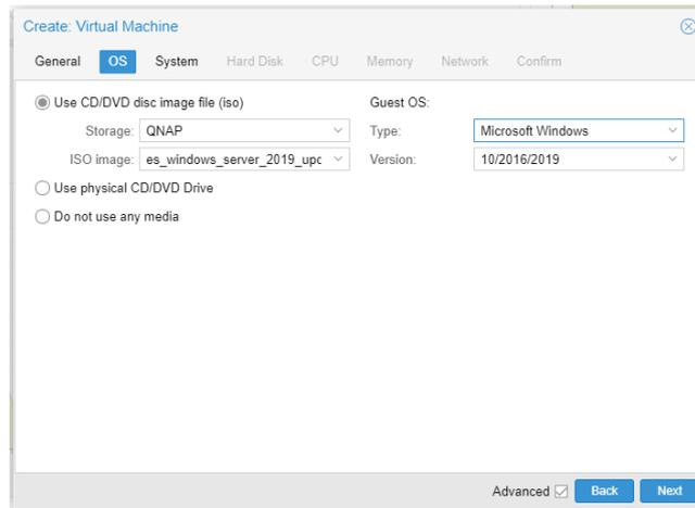
3. En el apartado System, marcamos el Qemu Agent. El resto de los parámetros se dejarán por defecto. Es importante que el SCSI controller sea VirtIO SCSI, de cara a la configuración posterior del disco de sistema.
