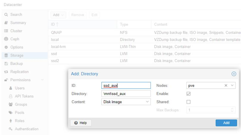
Este método funciona, y nos permite trabajar con máquinas virtuales perfectamente, pero si queremos, por ejemplo, realizar Snapshots, no vamos a poder. Además, aunque se realizar de forma nativa con el sistema operativo Debian en el que se aloja Proxmox, no es la forma más sutil de realizarlo.
